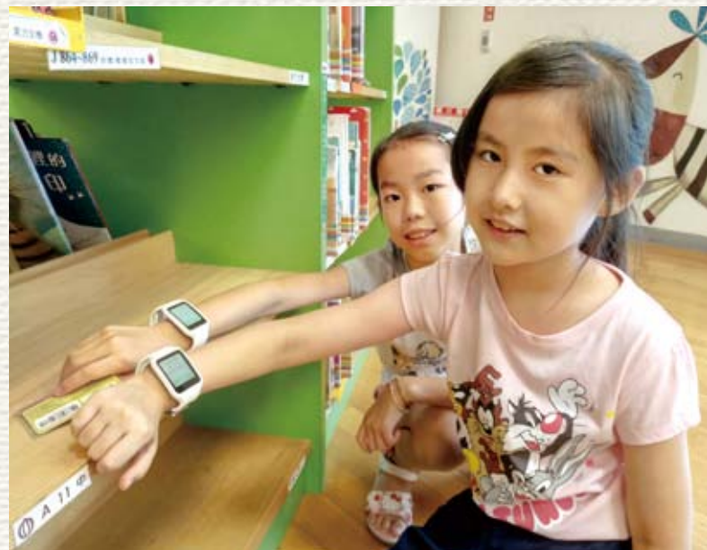
抵達所在書架後，手錶能進一步顯示書籍放置的架位，並以簡易水果及數字標示，提升圖書尋獲率。
