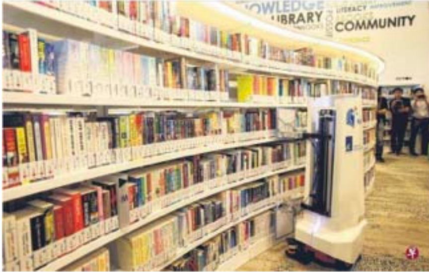
圖4 AuRoSS機器人夜間掃描書架的情形
