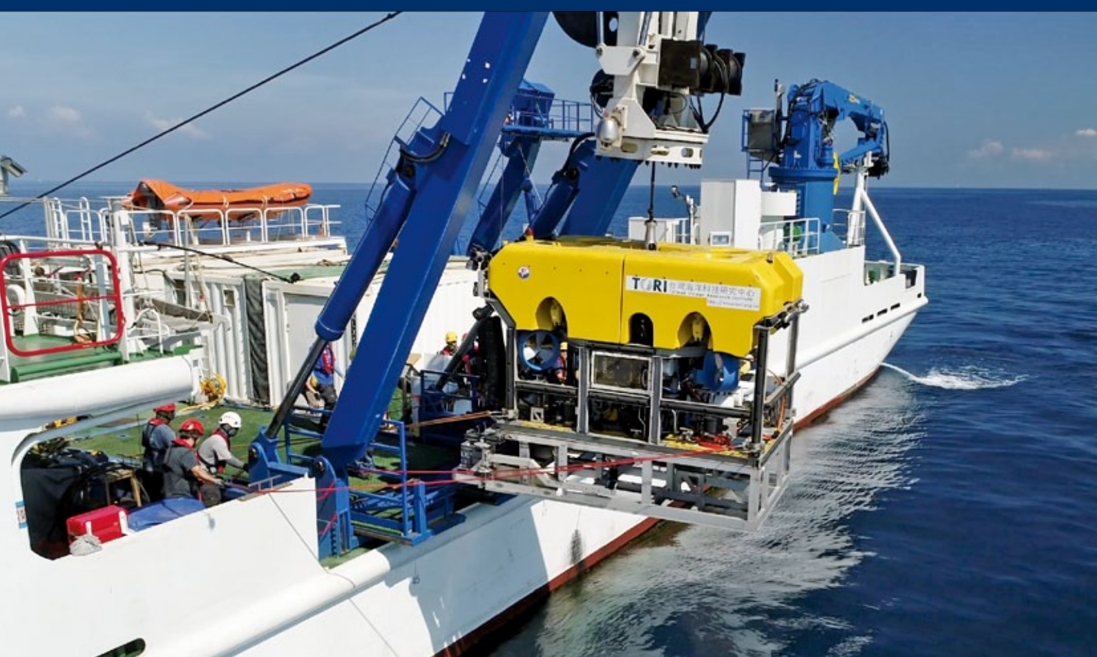
▲ 6 噸重的 ROV 靠著大型的工作母船才能出海作業。
