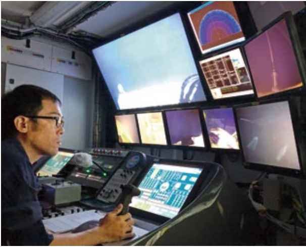
▲ 工作母船上的控制室是操作 ROV 的核心。
