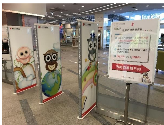
圖 7 RFID 通道偵測門禁系統設備
