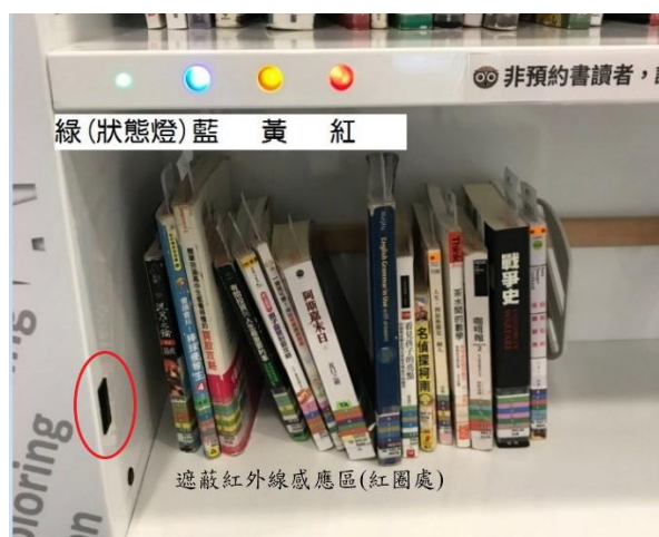
圖 4 RFID 智慧型書架設備圖
