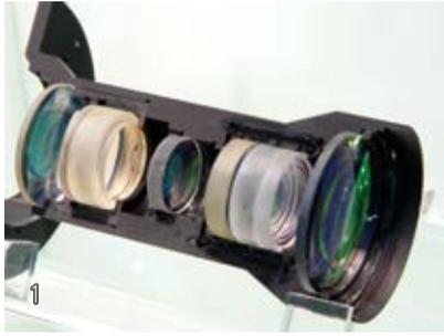
1 機載取像儀 (Vegetation and Change Detection Imager, VCDi) 鏡頭剖視構造。
