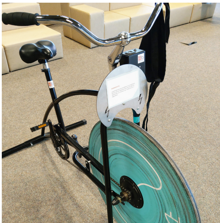
館內設置了一臺自助充電腳踏車
