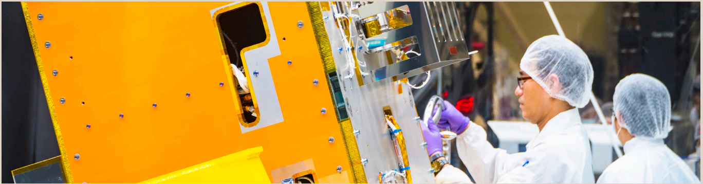
獵風者衛星於國家太空中心整測廠房進行慣性參考單元極性測試作業
