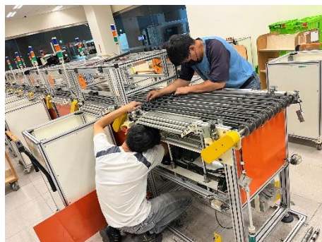
圖 196 汰換總館自動分類及分揀系統還書設備之壓輪、門檔收編護套等設備，使其運轉更為流暢，提升還書分揀效率與效能。
