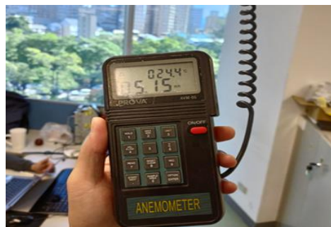
圖 195 送風機量測風量值 5.15m/s(清洗前為 1.2m/s)
