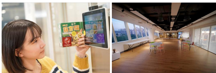
圖 57 多合一門禁系統有密碼、晶片、QR-code、人臉、櫃台、API 等六種解鎖方式。
