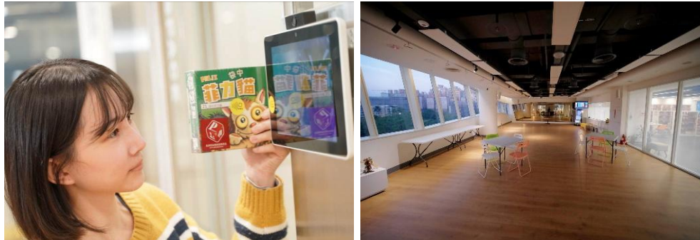
圖 50 多合一門禁系統有密碼、晶片、QR-Code、人臉、櫃台、API 等六種解鎖方式
