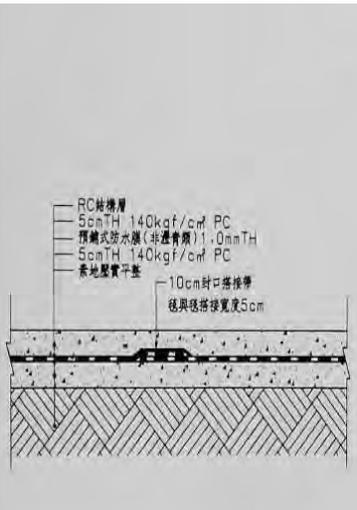
**防水性材料未過濾材料商圖說實例**
