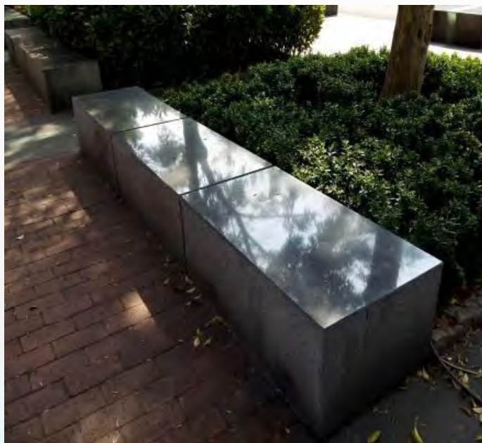
以石粉攪拌樹脂壓鑄或窯燒成型之仿石材料實體
