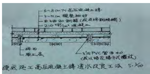
高壓混凝土地面磚（透水）詳圖
