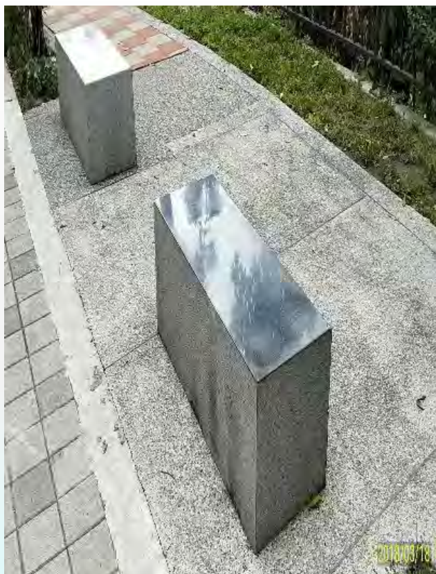
以石粉攪拌樹脂壓鑄或窯燒成型之仿石材料實體
