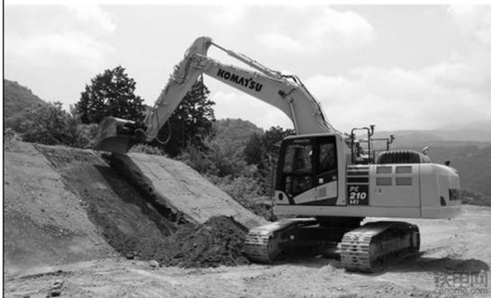
小松首台智慧挖掘機以ICT中的IMC（智慧機器控制）技術為核心，配備了GNSS天線、IMU+（慣性測量單元）、行程感應油缸和控制器等等。
