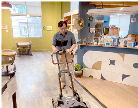
圖2-1 設計前先以透地雷達檢閱地下結構物狀態
