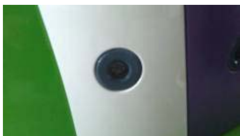
圖 6 超音波感測器(感測距離 20CM)
