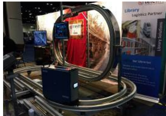
自動運輸系統軌道，可以垂直運送
