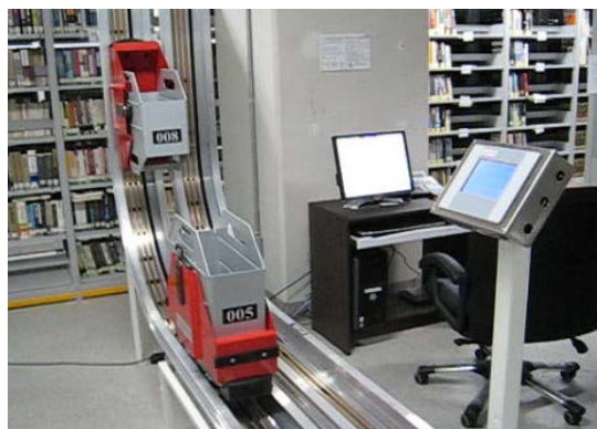
南韓京畿道立圖書館自動圖書運輸系統其取代人力功能以運輸為主，歸架及取書仍須藉助人力。
