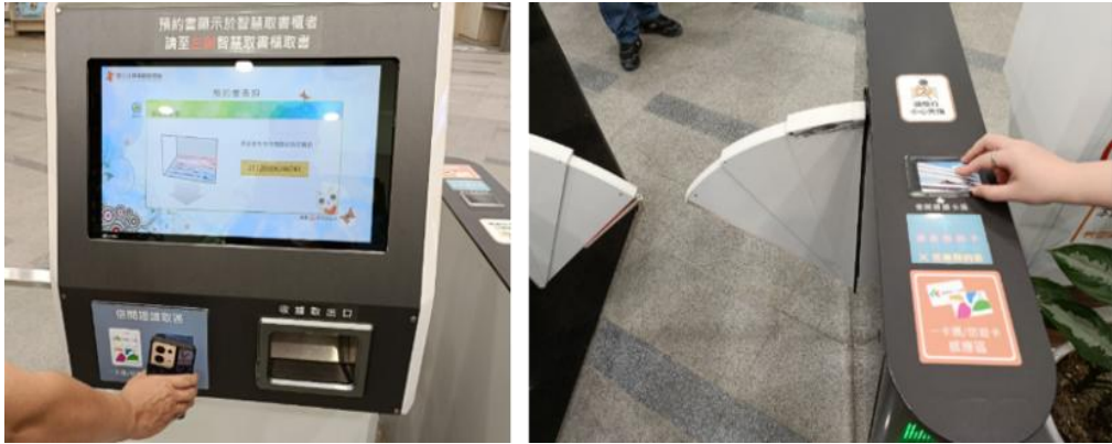
圖 217 智慧型 RFID 書架設備及預約取書服務整合系統，能確保本館自助取書服務順暢
